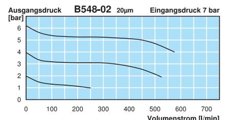
\*1 bei 7 bar Eingangsdruck, 6 bar Ausgangsdruck und 1 bar Druckabfall
