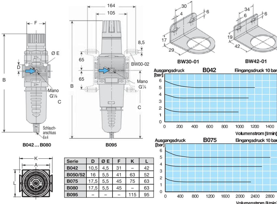
\*1 bei 10 bar Eingangsdruck, 6 bar Ausgangsdruck und 1 bar Druckabfall
